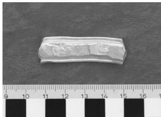
Fig. 1. U3386, guld-tacka, hamrad i två lager med profilerade kanter, vikt 30,74 g. Sammansättningen är guld 90%, silver 9%, koppar knappt 1%, samt spår av tenn, järn, platina och vismut. Sannolikt tillverkad av naturligt förekommande vaskguld, t ex från övre Rhendalen.
