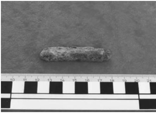
Fig. 4. U916, D-formad tacka i tennhaltig mässing. a) makrobild, b) BSE-bild visande diffusa mässingkorn, något tennhaltiga (ljusare på bilden) längs korngränserna, samt droppar av bly (vita). Förstoring enligt skalstrecket i vänstra nedre hörnet.
